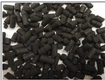
ナノ粒子鉄ペレット( \text{Fe}/\text{Fe}_3\text{O}_4 )
