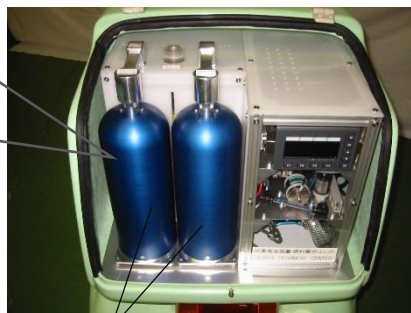
ナノ粒子鉄ペレット充填カートリッジ
